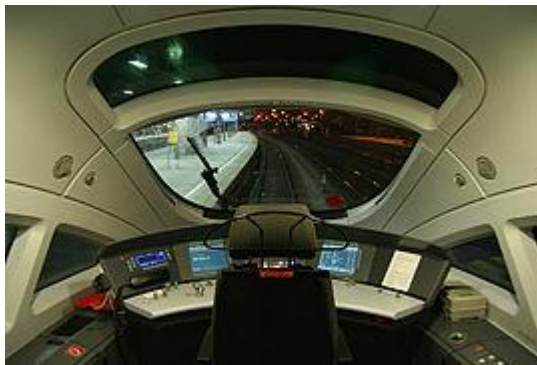
Кабина машиниста скоростного электропоезда ICE 3
