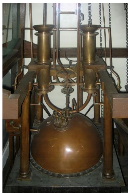
Модель (слева) и воспроизведение паровой машины И. Ползунова
